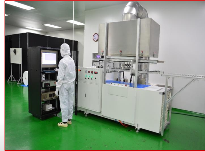
Test hiệu suất lọc Hepa (Scan Test)
